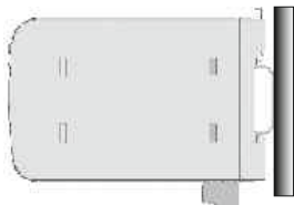
Rys. 3 Montaż na szynie TS-35 (DIN)
